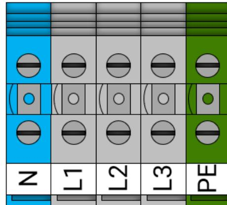
No olvidar de conectar el cable de tierra (PE) en su borna correspondiente.
